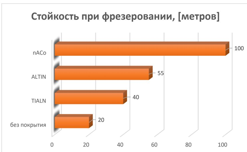
Количество пройденных метров фрезой 1.0 мм с различными покрытиями
